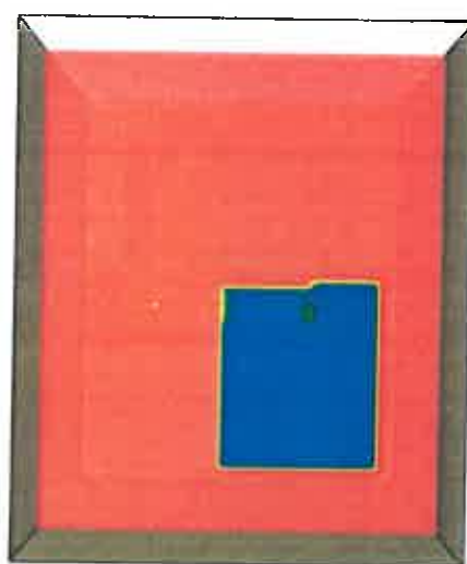
Zakres widoczności na poziomie 1,8 m od podłogi po upływie 311 s.
