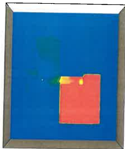
Zakres temperatury na poziomie 1,8 m od podłogi po upływie 120 s.
