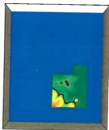
Zakres temperatury na poziomie 1,8 m od podłogi po upływie 60 s.
