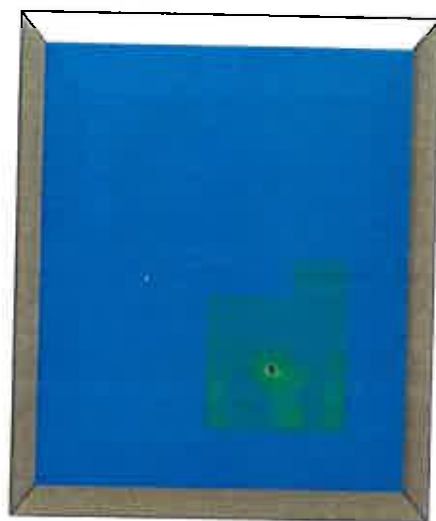
Zakres temperatury na poziomie 1,8 m od podłogi po upływie 30 s.
